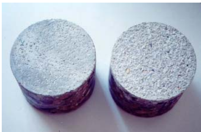
Obr. 2 Povrch betonu po testu zmrznutí / tání ve slaných roztocích
