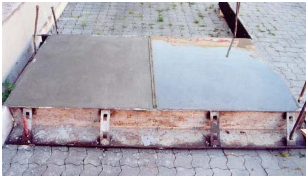
Obr. 1 Zkušební deska, levá část bez AF, pravá část s AF
